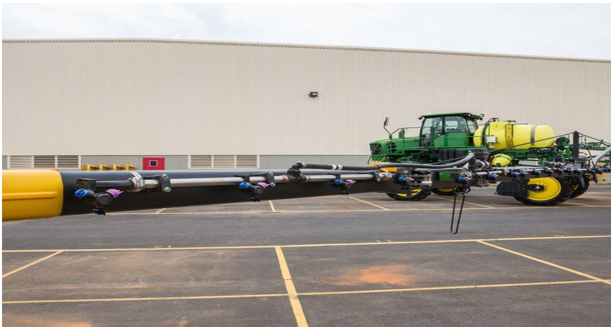
Slika 25. Grana traktorske prskalice – karbonska vlakna i epoxy
