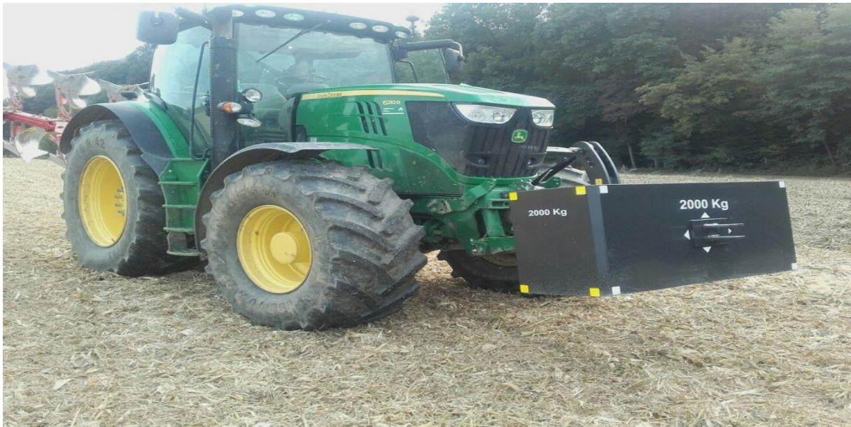
Slika 31. Traktorski uteg (beton ojačan PP vlaknima sa čeličnim okvirom)
