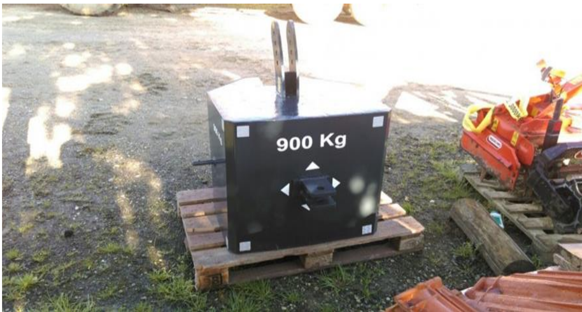
Slika 17. Traktorski uteg (beton ojačan PP – vlaknima) sa čeličnim okvirom
