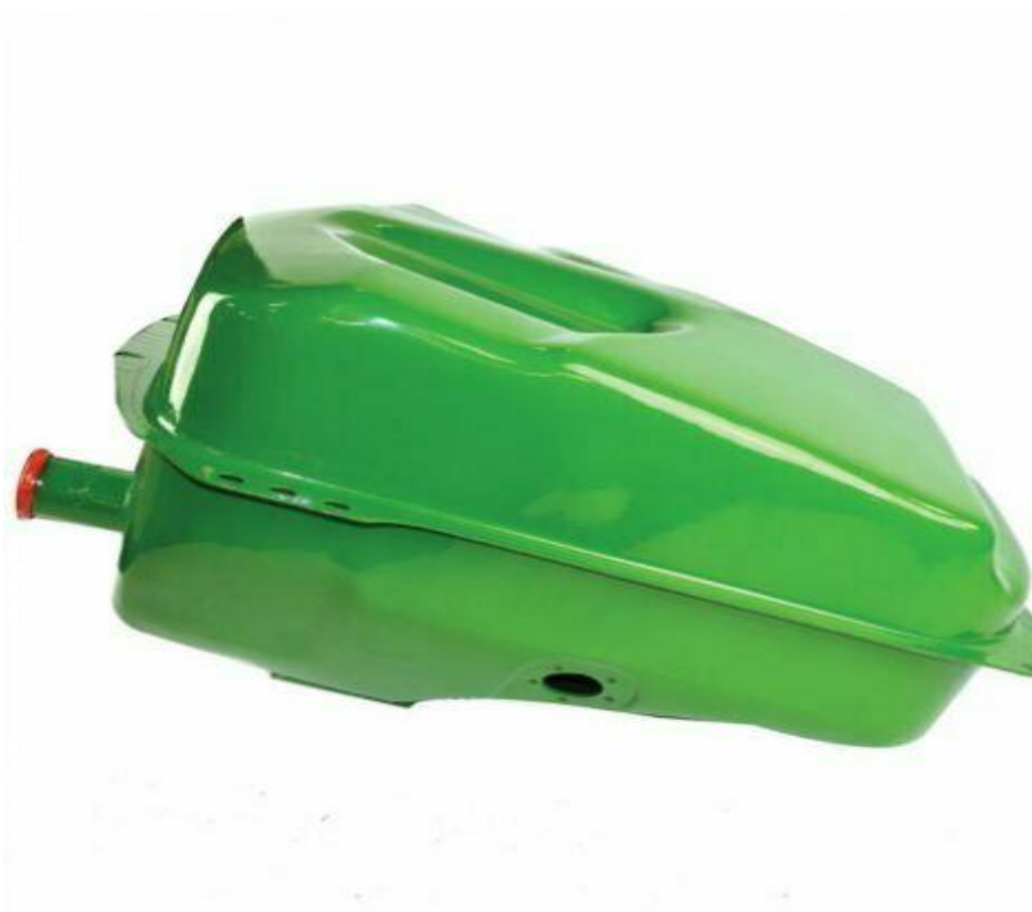
Slika 25. Traktorski spremnik goriva (stakloplastika)
