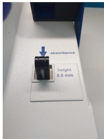
Slika 20. Postavljanje UV kivete u spektrofotometar
