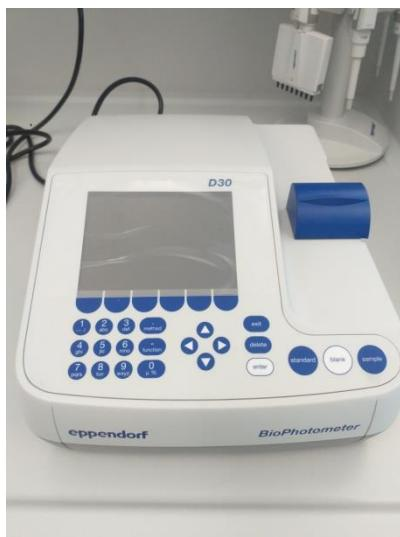
Slika 18. Spektrofotometar
