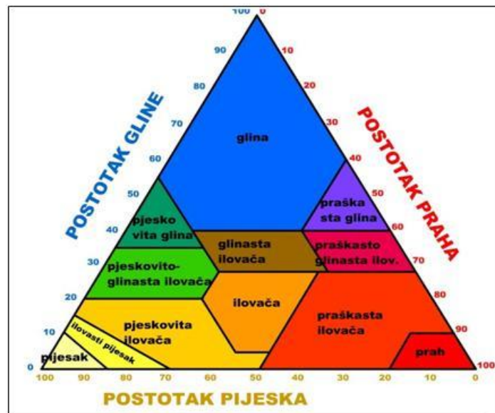
Slika 2. Teksturni trokut ((Soil Survey Staff, 1951.), prilagodio:autor )
