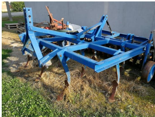
Slika 3. Podrivač proizvođača Rabewerk radnog zahvata 2,5 m (Izvor: Vlastita fotografija)
