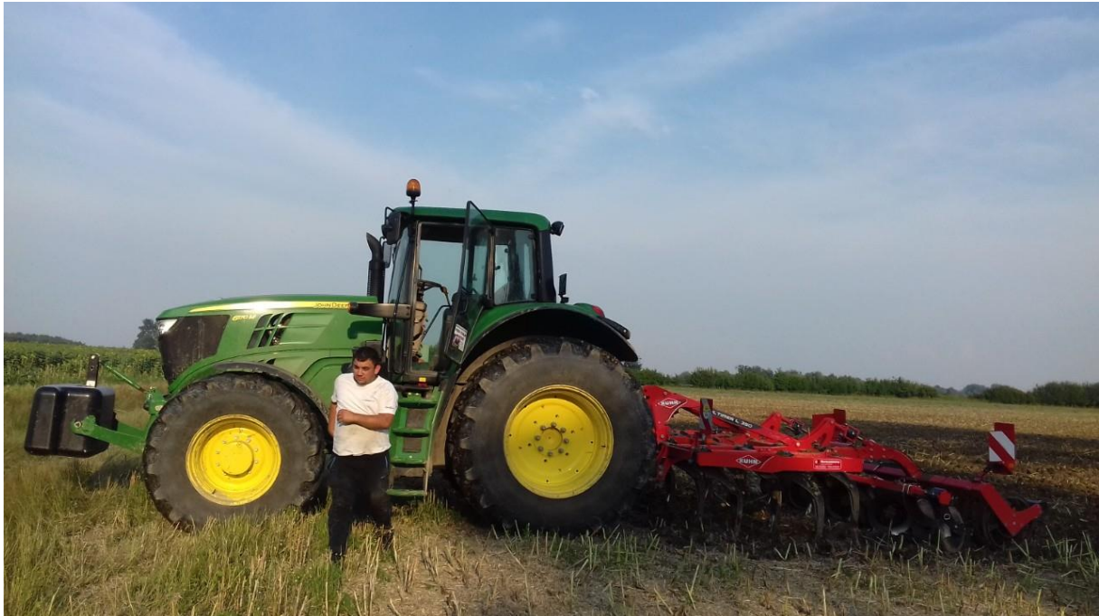
Slika 3. Obrada tla s gruberom (izvor: Mandić, M.)
