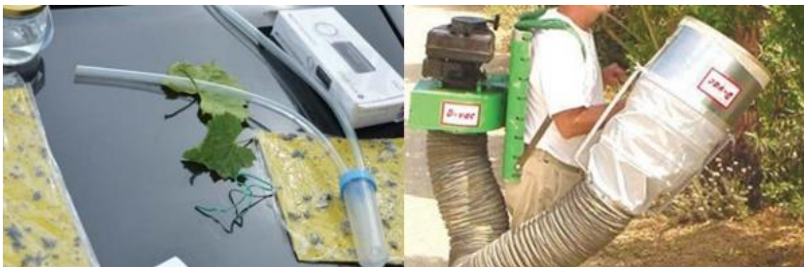
Slika 12. Ručno izrađeni aspirator (lijevo) i leđni aspirator (desno) (Izvor: www.winetwork-data.eu )
