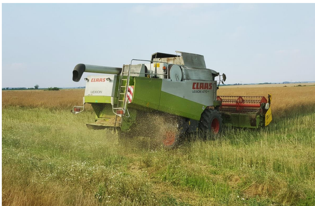
Slika 10. Žetva kombajnom sa žitnim headerom i stolom za uljanu repicu
