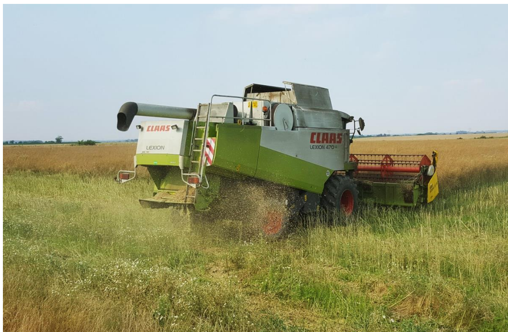
Slika 10. Žetva kombajnom sa žitnim headerom i stolom za uljanu repicu
