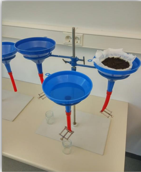
Slika 7. Baermannova metoda lijevka
