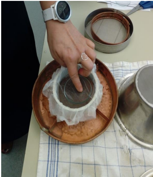
Slika 26. Ekstrakcijsko sito sa satnim stalom
