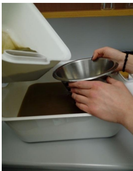
Slika 17. Pretakanje kroz sito od 365 \mu\text{m}
