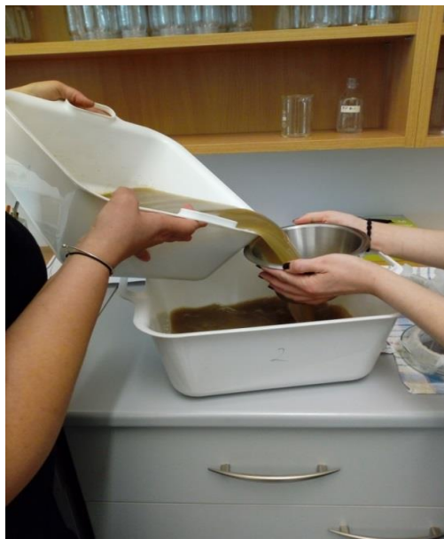
Slika 19. Pretakanje suspenzije kroz sito od 180 \mu m
