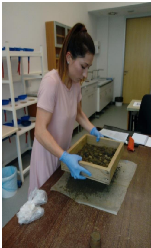
Slika 31. Prosijavanje tla (Foto: L. Pavlic)
