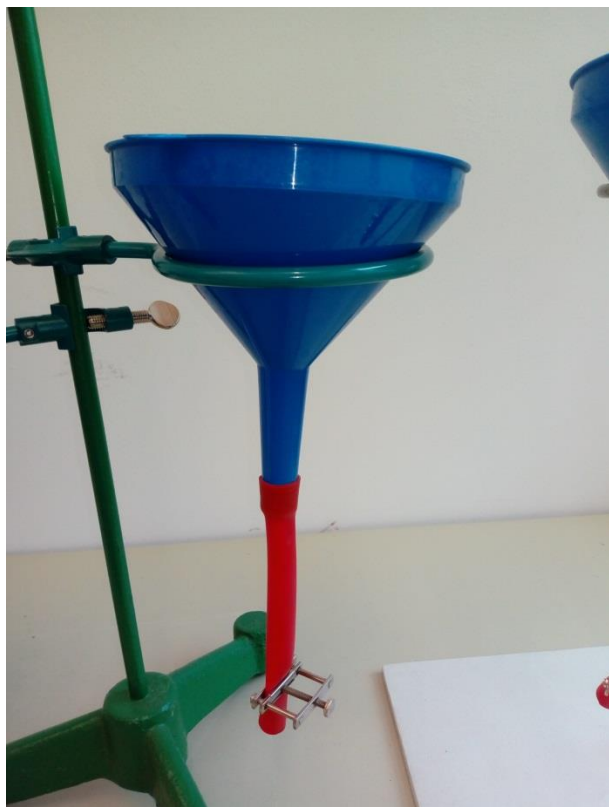
Slika 29. Pribor za metodu lijevka (Foto: L. Pavlic)
