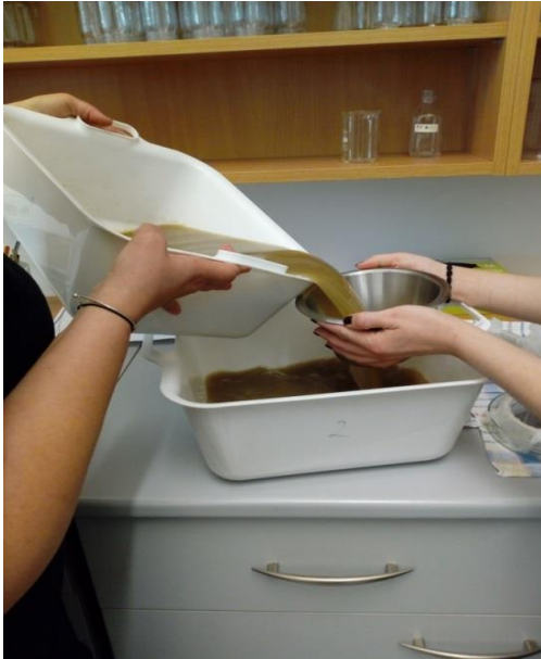
Slika 19. Pretakanje suspenzije kroz sito od 180 \mu m
