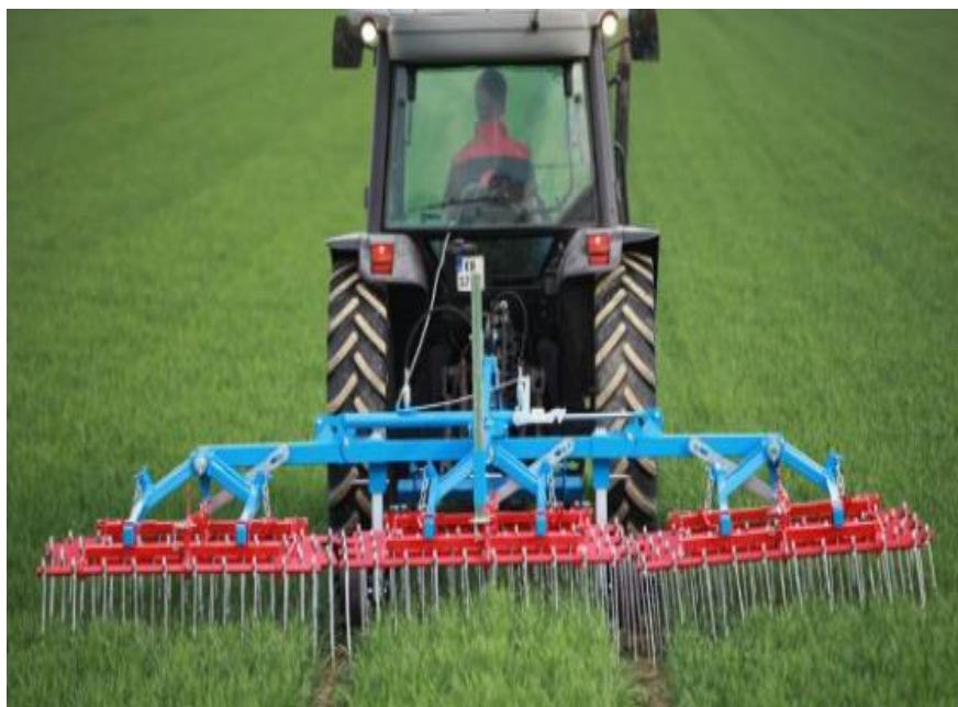
Slika 13. Kultivacija tla pomoću brane s opružnim zupcima
