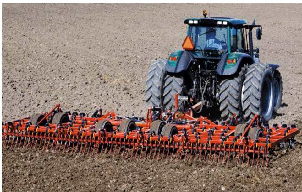
Slika 8. Drljanje tla radi optimizacije stanja tla za klijanje sjemena, nicanje i razvoj usjeva
