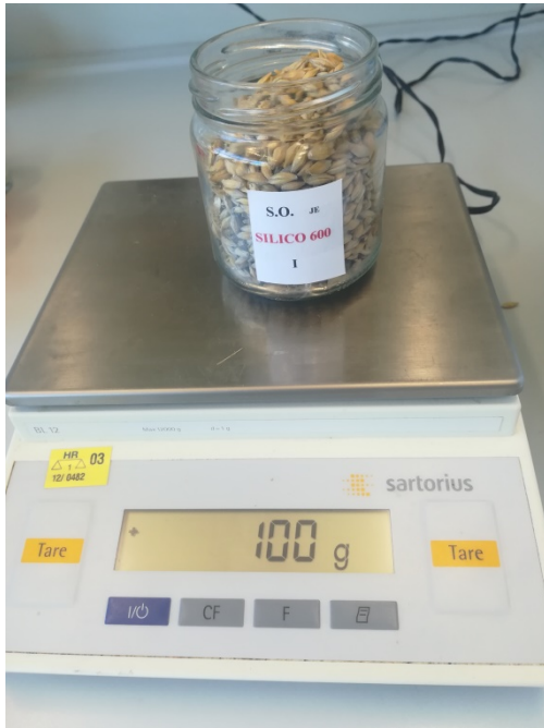
Slika 10.: Vaganje 100g sjemena ječma za uzorak Foto: Popić Martina
