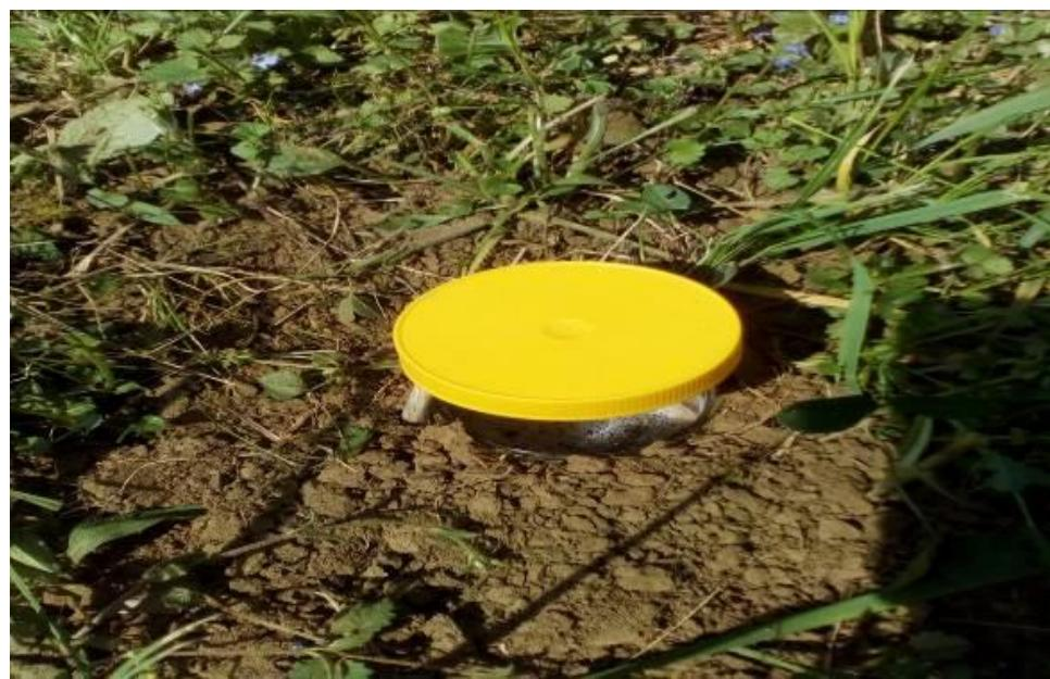
Slika 22. Poklopljena staklena posuda radi zaštite od nečistoća
