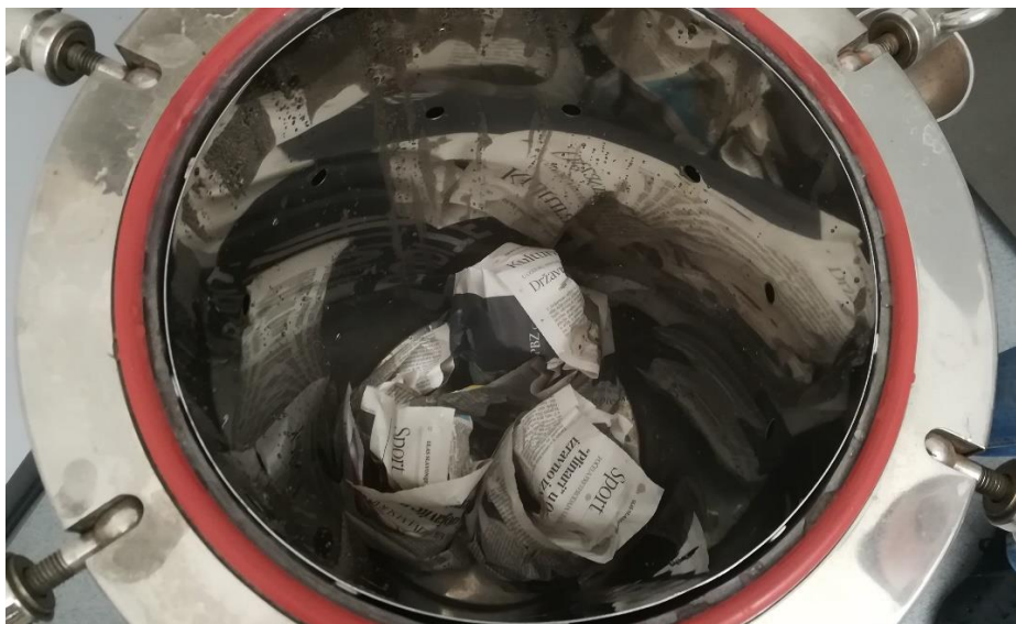
Slika 11. Tikvice s hranjivom podlogom omotane u novine u autoklavu (foto: S. Petrošević, 2019.)
