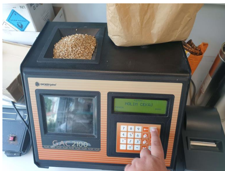
Slika 3. Mjerenje hektolitarske mase (Izvor: Šormaz, S.)
