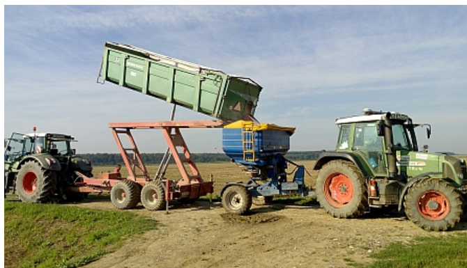
Slika 15. Punjenje rasipača Bogballe M3W pretovarnom prikolicom (Izvor: Stracenski, 2015.)
