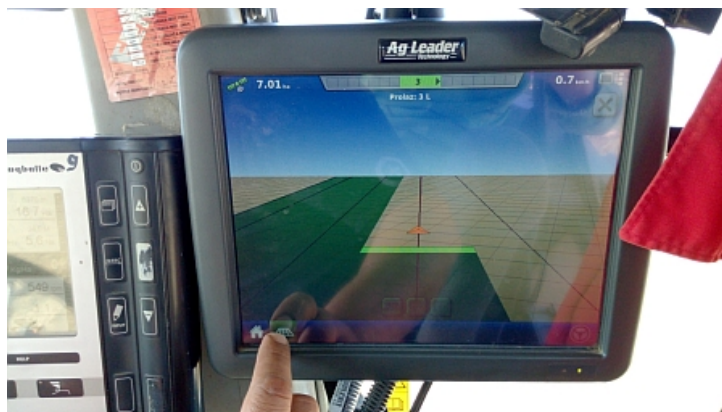
Slika 12. Prikaz prohoda traktora i rasipača na monitoru Integra (Izvor: Stracenski, 2015.)
