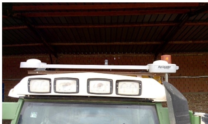
Slika 13. GPS antena postavljena na krovu traktora (Izvor: Stracenski, 2015.)
