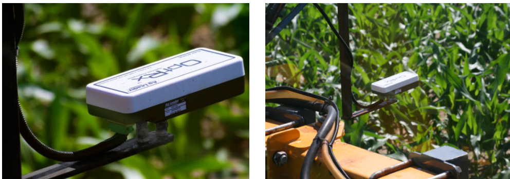
Slika 17. OptRx senzor (Izvor: www.findri.hr )
