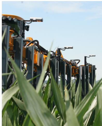
Slika 19. Skeniranje usjeva OptRx senzorom (Izvor: www.findri.hr )
