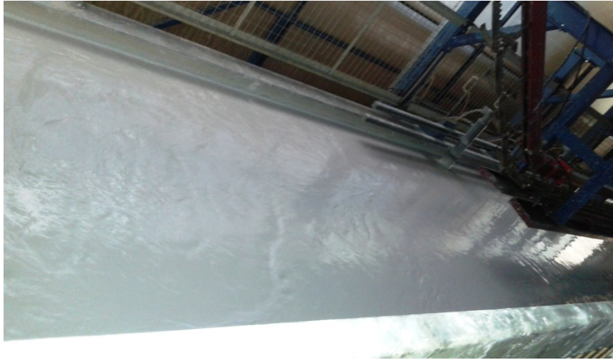
Slika 26. Bazen za ispiranje naplataka (autor)
