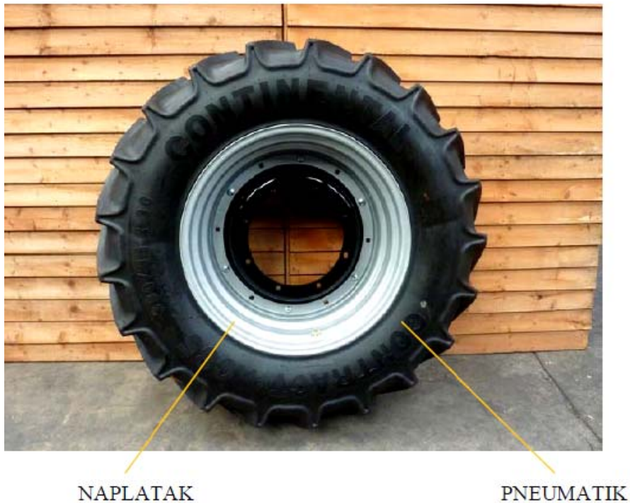
Slika 1. Glavni dijelovi kotača (autor)
