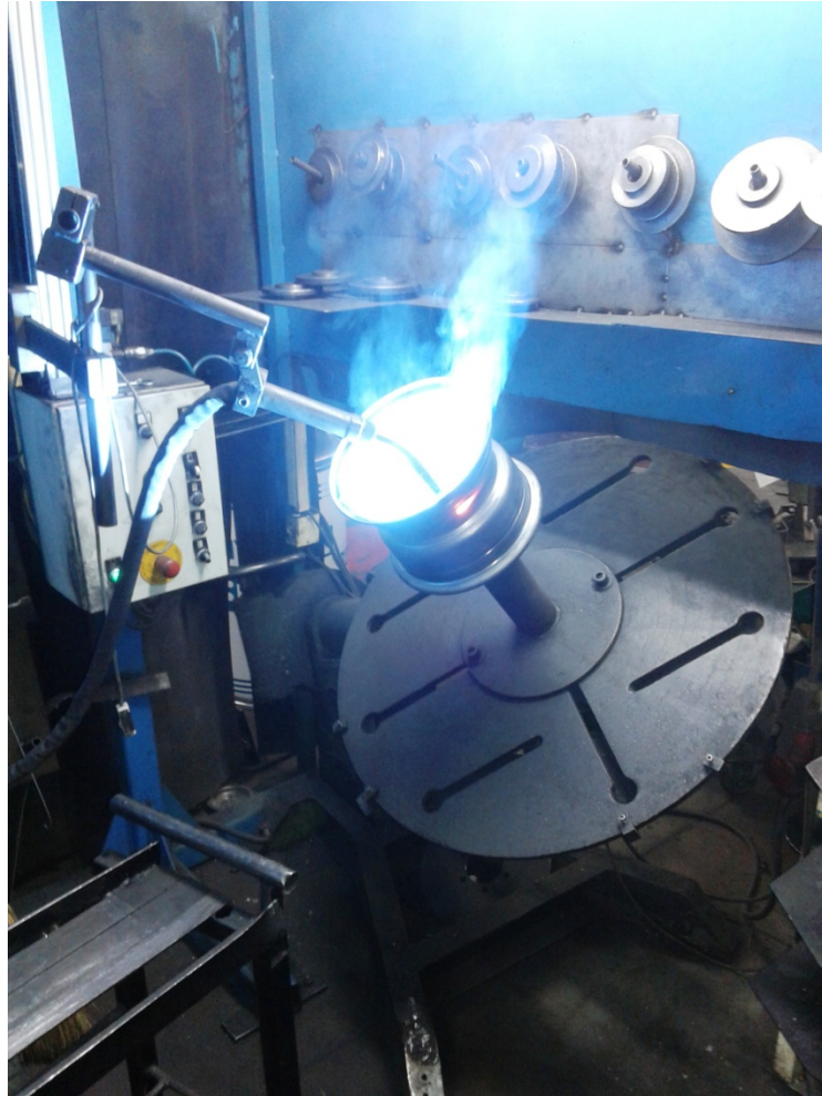
Slika 25. Zavarivanje plašta i diska (autor)
