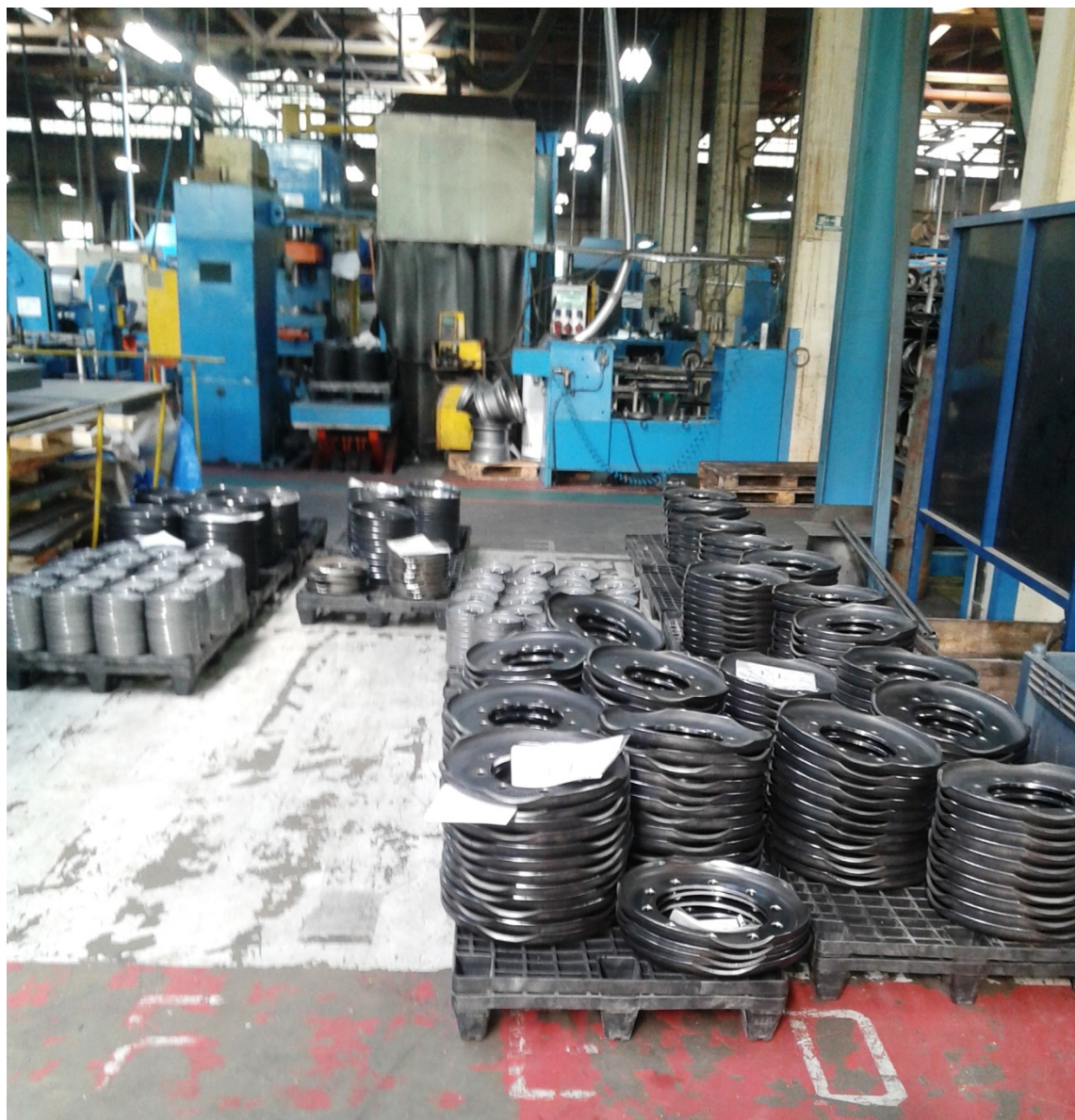
Slika 16. Završeni središnji diskovi naplatka (autor)
