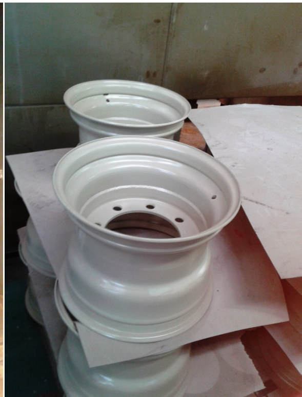
Slika 28. Naplatak obojan temeljnom bojom (autor)
