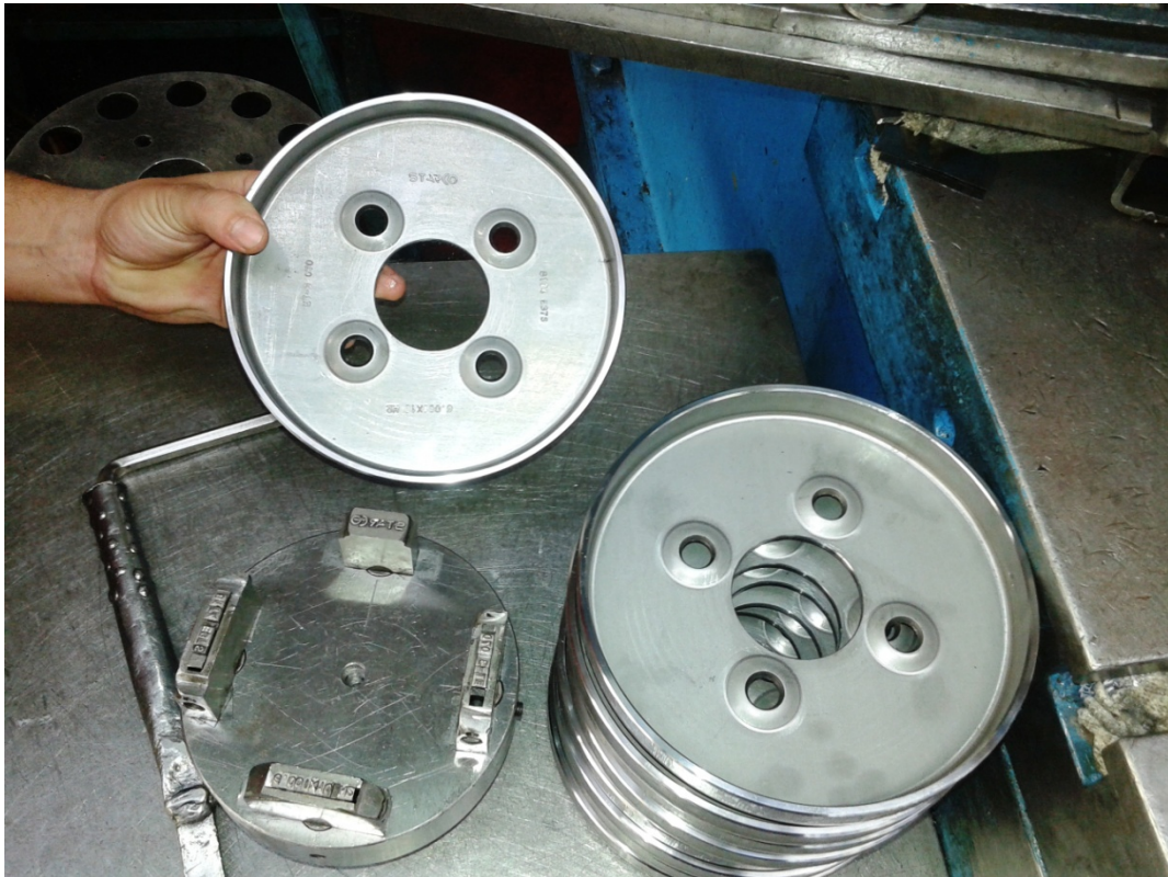
Slika 15. Središnji disk sa utisnutim znakama i žig za utiskivanje (autor)
