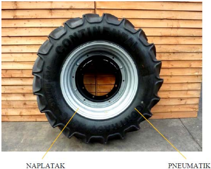
Slika 1. Glavni dijelovi kotača (autor)
