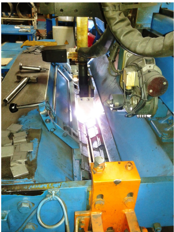
Slika 18. Zavarivanje plazmom (autor)
