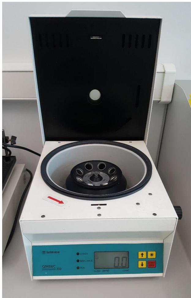
Slika 12. Centrifuga potrebna za čišćenje i sedimentaciju nematoda
