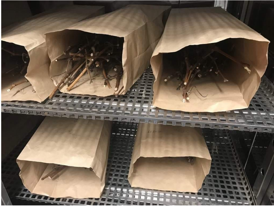
Slika 9. Sušenje prosječnih uzoraka u sušioniku
