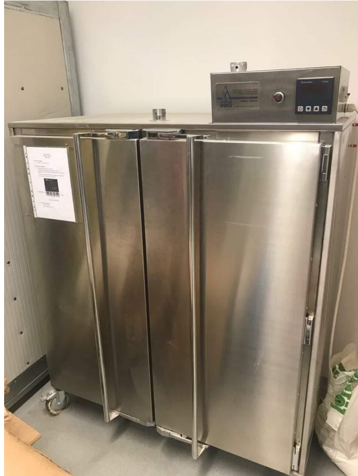
Slika 8. Sušionik (ST 800 T, 5000 W)
