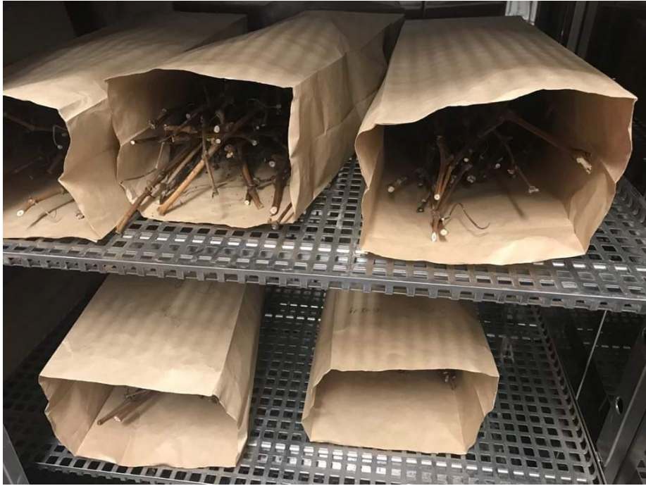
Slika 9. Sušenje prosječnih uzoraka u sušioniku
