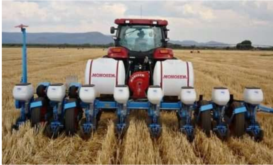
Slika 18. Sijačica za sjetvu bez obrade tla ( https://blog.agrivi.com/hr/post/najbolje-prakse-za-iskoristenje-poslijezetvenih-ostataka )
