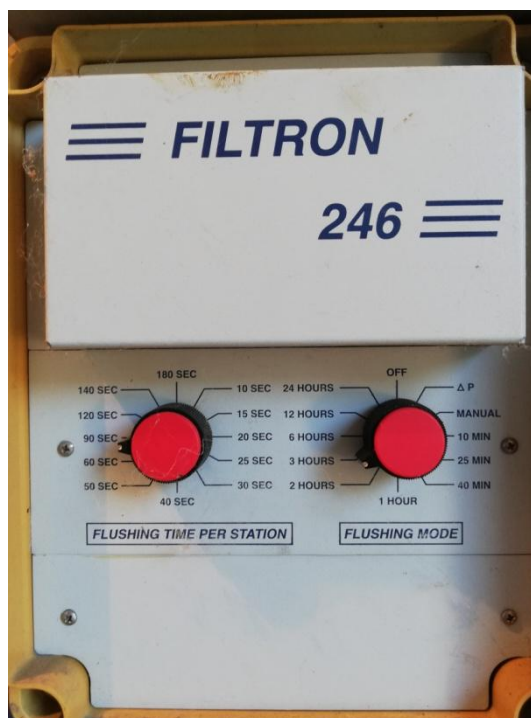
Slika 8: Kontrole za određivanje automatskog ispiranja filtera izvor: Mirna Škoro (2019.)
