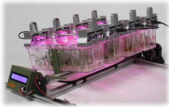
**Slika 19.** MICROROCKER bioreaktor (TIB)
