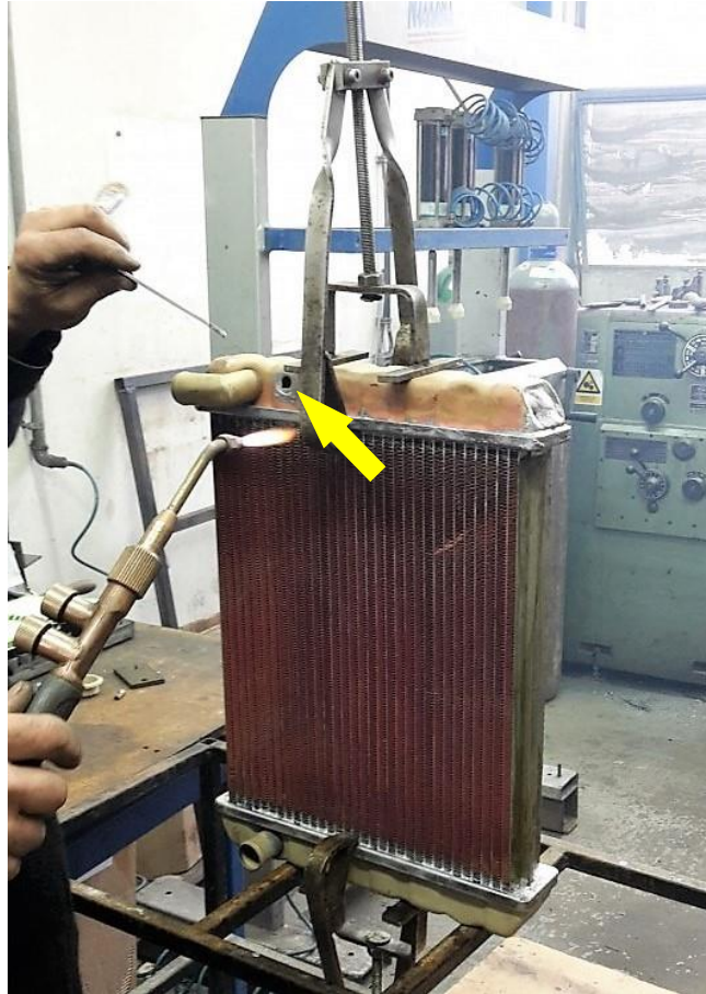
Slika 27. Popravak ispusta za rashladnu tekućinu na hladnjaku plinskim lemljenjem (Izvor: http://www.var.hr/hladnjaci-2/servis-hladnjaka/ )
