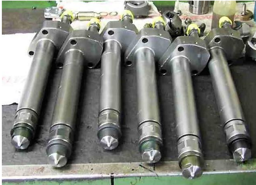
Slika 30. Brizgaljke dizel motora (Izvor: http://www.hagemann-diesel.com/start.htm )
