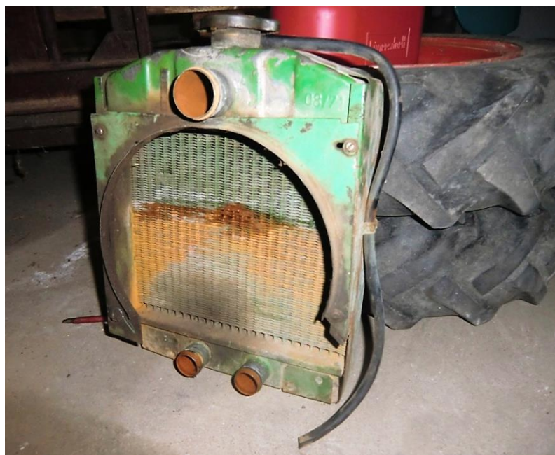
Slika 24. Primjer oštećenog hladnjaka traktora
