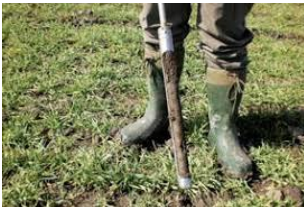
Slika 2. Uzimanje uzoraka cilindričnom sondom 0-30 cm
