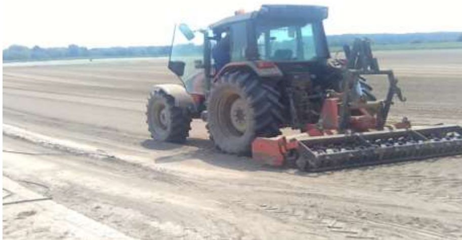
Slika 1. Priprema zemljišta za sjetvu rotodrljačom
