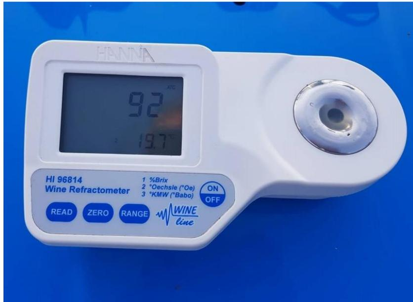
Slika 7. Refraktometar korišten u pokusu (Izvor: Autor)
