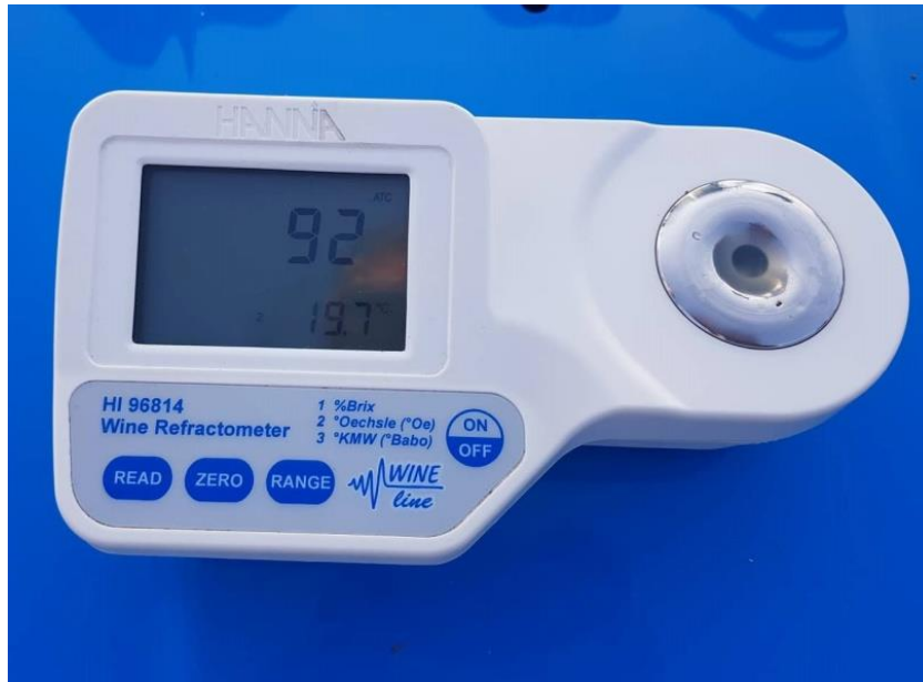
Slika 7. Refraktometar korišten u pokusu (Izvor: Autor)
