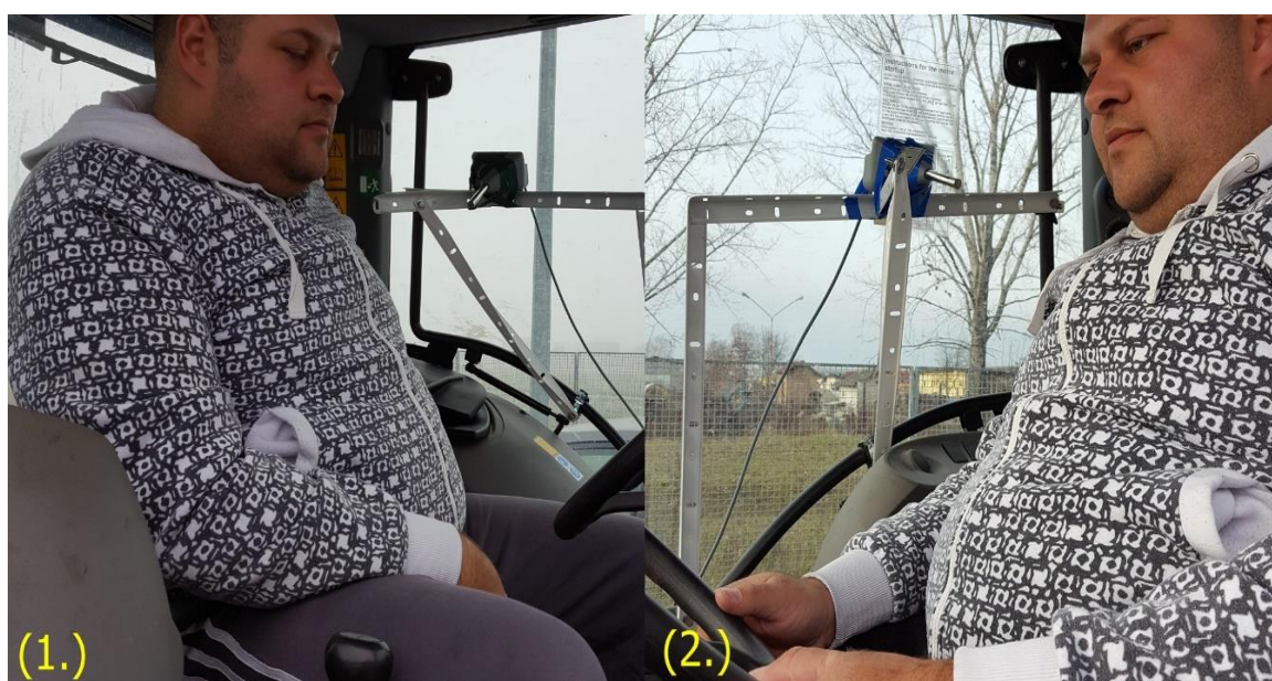
Slika 8. Postavljeni zvukomjer s lijeve (1.) i s desne (2.) strane pri mjerenju na trakama i agrotehničkim podlogama
