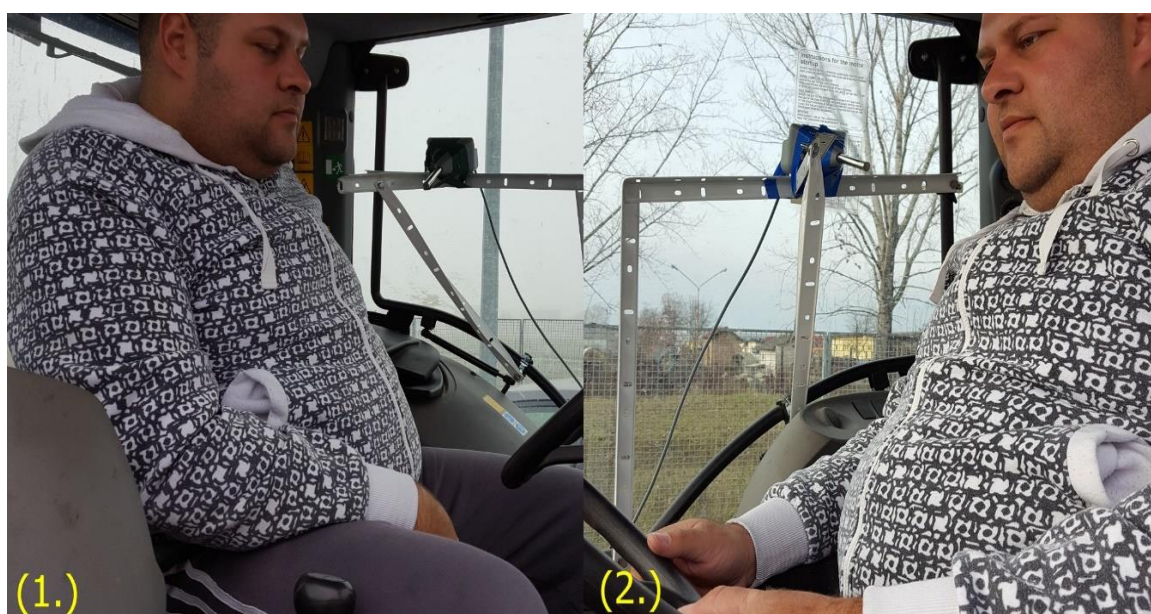
Slika 8. Postavljeni zvukomjer s lijeve (1.) i s desne (2.) strane pri mjerenju na trakama i agrotehničkim podlogama
