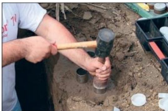
Slika 3. Utiskivanje cilindra po Kopeckom, (Lončarić i sur. 2014.)
