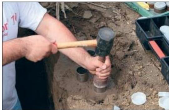
Slika 3. Utiskivanje cilindara po Kopeckom, (Lončarić i sur. 2014.)
