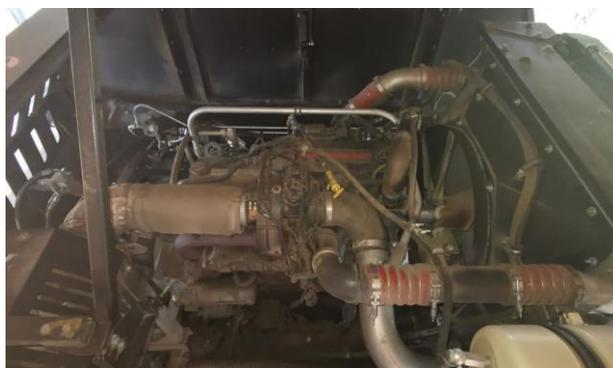
Slika 17. Motor *Cummins* kombajna „*Rostselmash VECTOR 425*“
