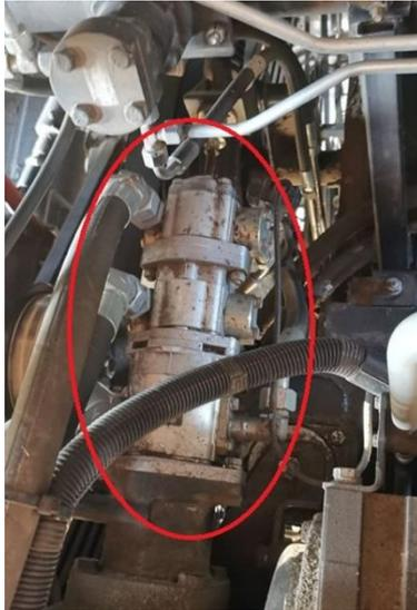
Slika 18. Hidraulična crpka kombajna „Rostselmash VECTOR 425“
