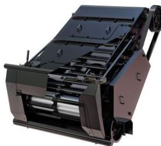
Slika 6. Elevator žitne mase kombajna „Rostselmash VECTOR 425“
