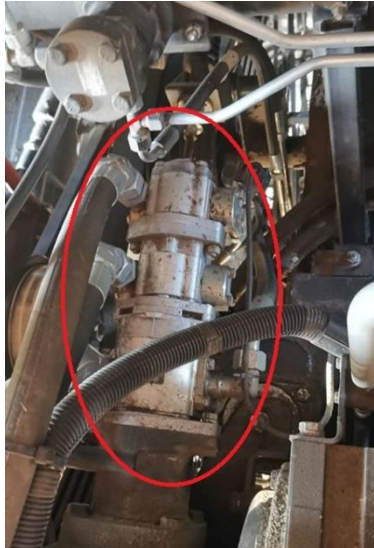
Slika 18. Hidraulična crpka kombajna „ Rostselmash VECTOR 425 “
