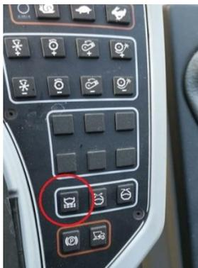
Slika 16. Tipka za uključivanje *hidropulzatora*
