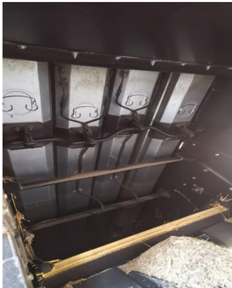
Slika 9. Donja zatvorena klizna površina slamotresa
