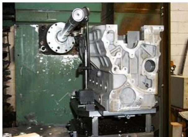
Slika 20. Obrada odlivenog kućišta motora na alatnom stroju
