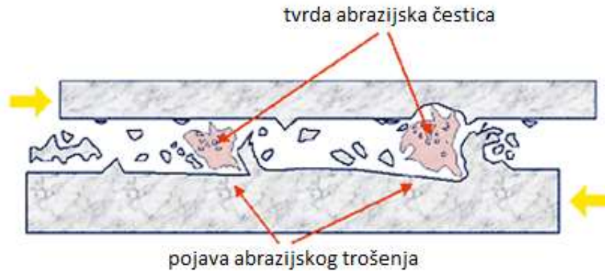
Slika 4. Abrazijsko trošenje materijala (Izvor: http://www.maziva.org )
