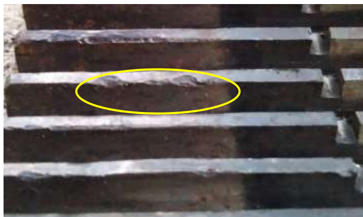
Slika 27. Jamičenje bokova zuba prstenastog sunčanog zupčanika (Izvor: Dario Raić, 2019.)
