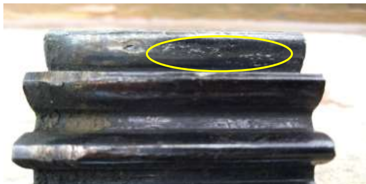
Slika 26. Jamičenje bokova planetarnog zupčanika (Izvor: Dario Raić, 2019.)
