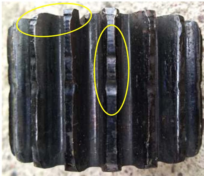
Slika 29. Plastične deformacije vanjskog oboda planetarnog zupčanika (Izvor: Dario Raić, 2019.)
