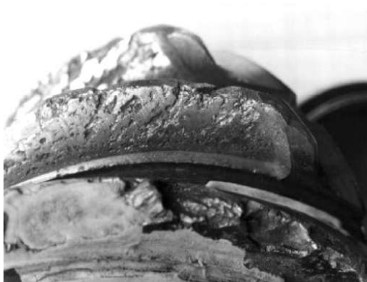
Slika 6. Zamor materijala reduktorskog zupčanika (Izvor: Rede, 2017.)
