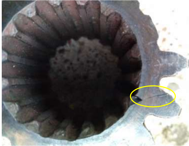
Slika 21. Pukotina na središnjem sunčanom zupčaniku (Izvor: Dario Raić, 2019.)
