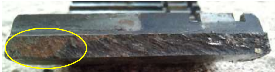
Slika 31. Korozija na mjestu prijeloma prstenastog zupčanika (Izvor: Dario Raić, 2019.)
