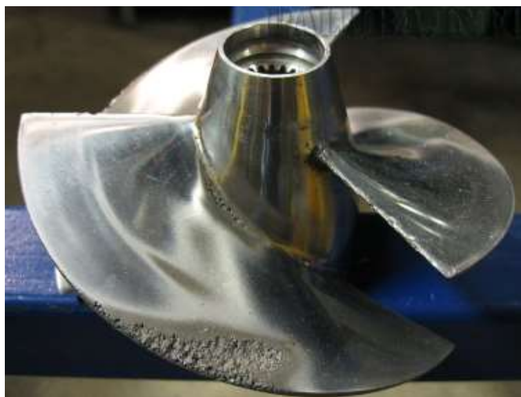
Slika 12. Kavitacijsko trošenje broskog vijka (Izvor: http://www.paluba.info )
