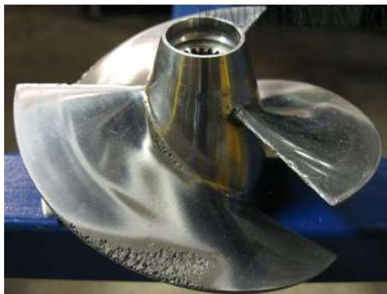
Slika 12. Kavitacijsko trošenje broskog vijka (Izvor: http://www.paluba.info )
