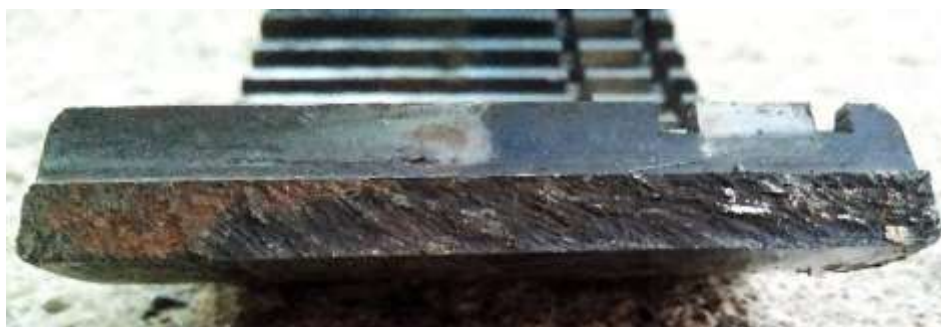
Slika 24. Mjesto prijeloma prstenastog sunčanog zupčanika (Izvor: Dario Raić, 2019.)
