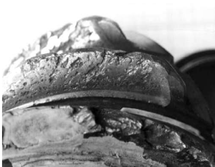
Slika 6. Zamor materijala reduktorskog zupčanika (Izvor: Rede, 2017.)
