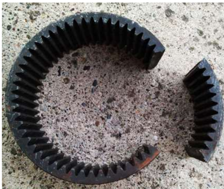
Slika 23. Lom prstenastog sunčanog zupčanika (Izvor: Dario Raić, 2019.)
