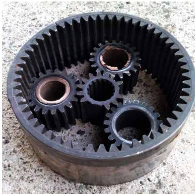
Slika 20. Zupčanci planetarnog prijenosnika bočnog reduktora traktora Fendt 936 Vario (Izvor: Dario Raić, 2019.)
