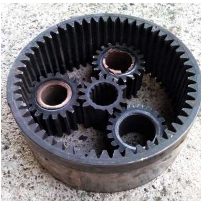
Slika 20. Zupčanicu planetarnog prijenosnika bočnog reduktora traktora Fendt 936 Vario (Izvor: Dario Raić, 2019.)
