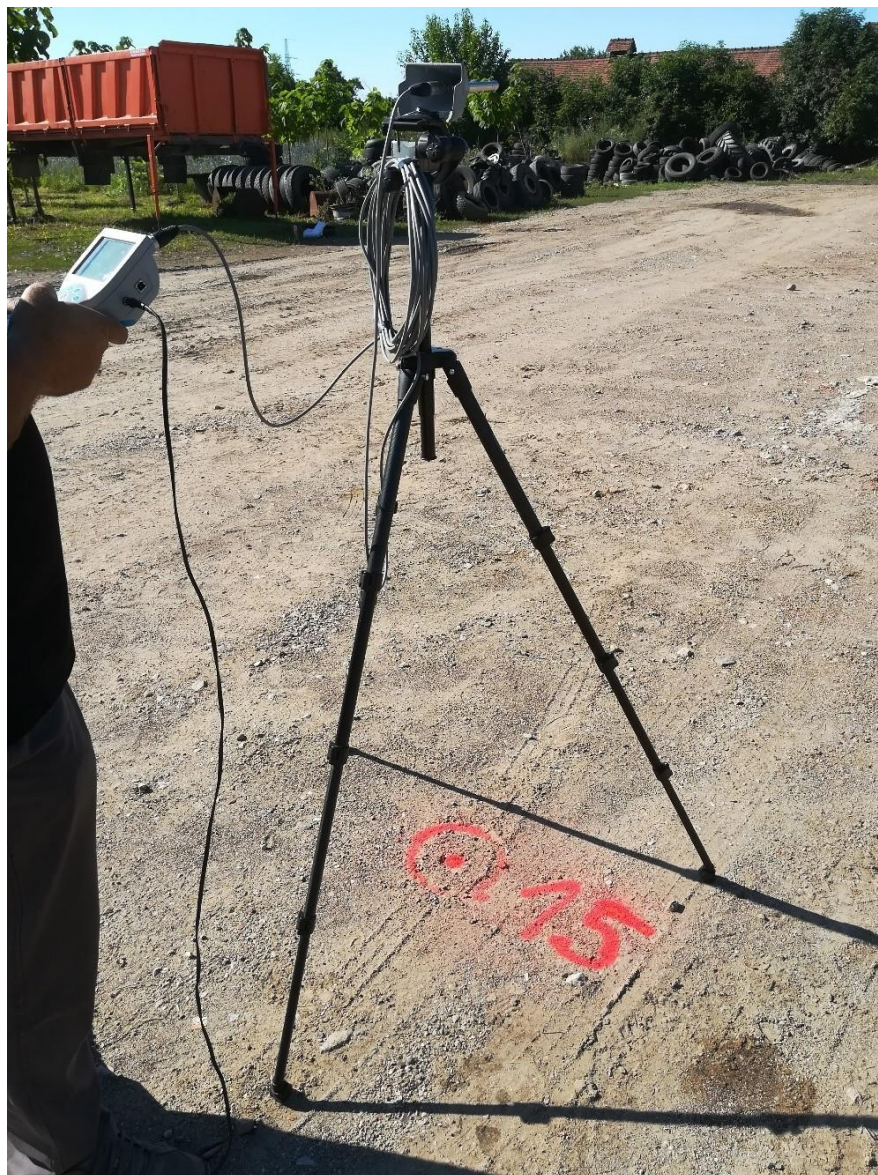
Slika 8. Uređaj za mjerenje buke Metrel Multinorm MI 6201 s pripadajućim mikrofonom (Izvor: vlastita fotografija)
