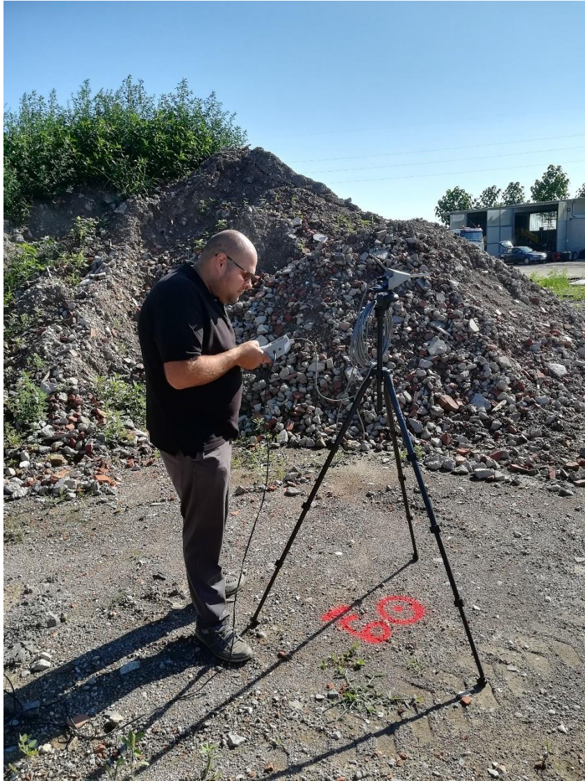
Slika 9. Mjerenje buke u točki br. 9 (Izvor: vlastita fotografija)
