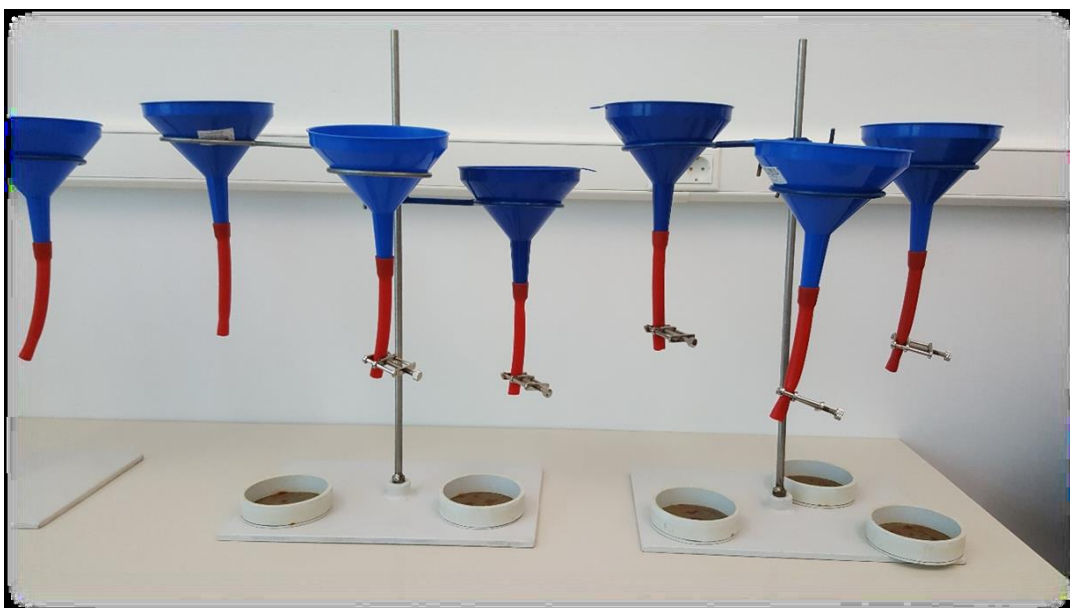
Slika 4. Lijeenci za izdvajanje nematoda Baermannovom metodom (Izvor: Tamara Siber, 2015.)
