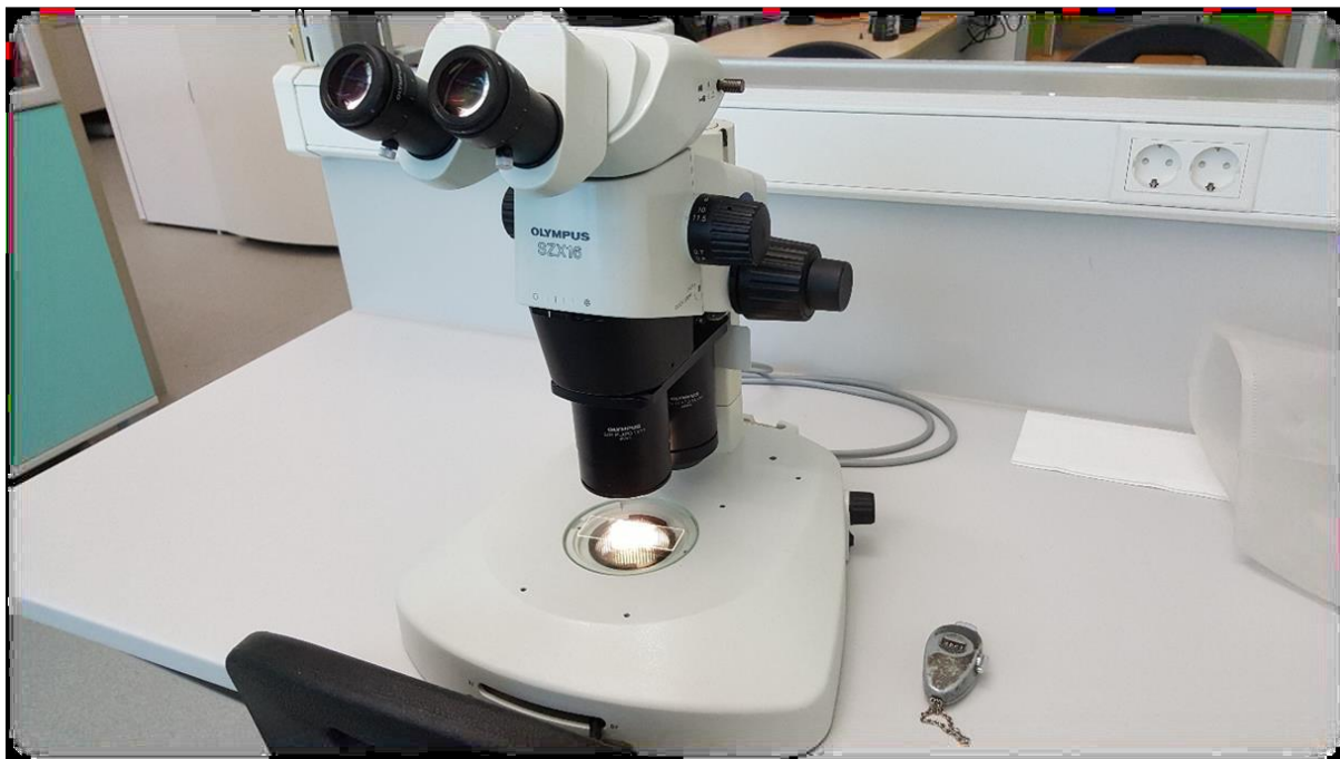
Slika 5. Mikroskop kojim se pregledavaju i determiniraju nematode (Izvor:Tamara Siber, 2015.)
