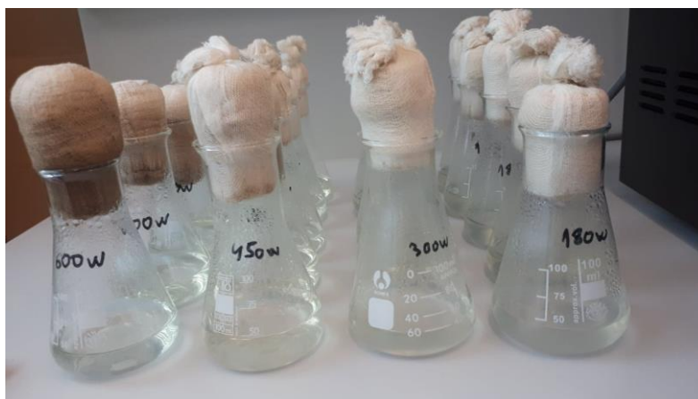
Slika 8. Isparavanje hranjive podloge nakon sterilizacije (s laboratorijskom čašom)
