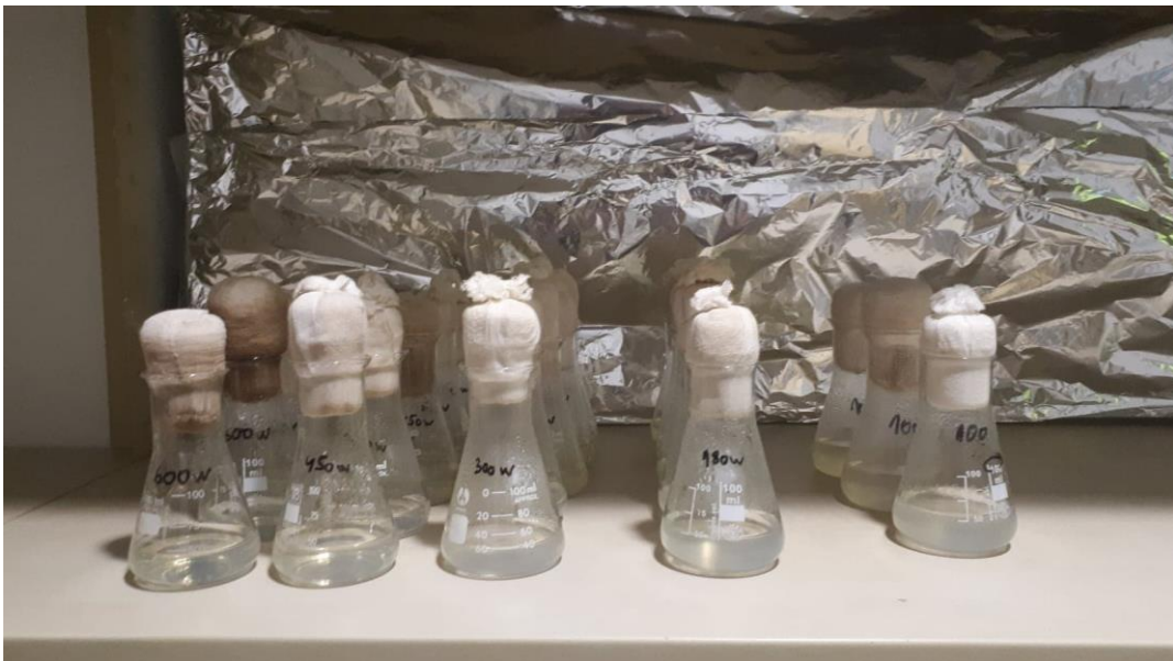
Slika 7. Erlenmayerove tikvice sa hranjivom podlogom zatvorene vatiranim čepovima u klima komori
