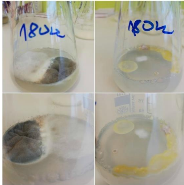
Slika 10. Zagađenost hranjive podloge kod tretmana na temperaturi od 180 W
