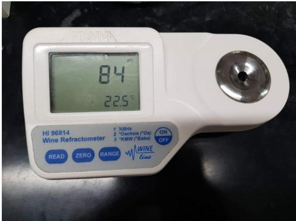
Slika 10. Refraktometar Hana Instruments 96814 ( Izvor: Mesarić, 2018.)
