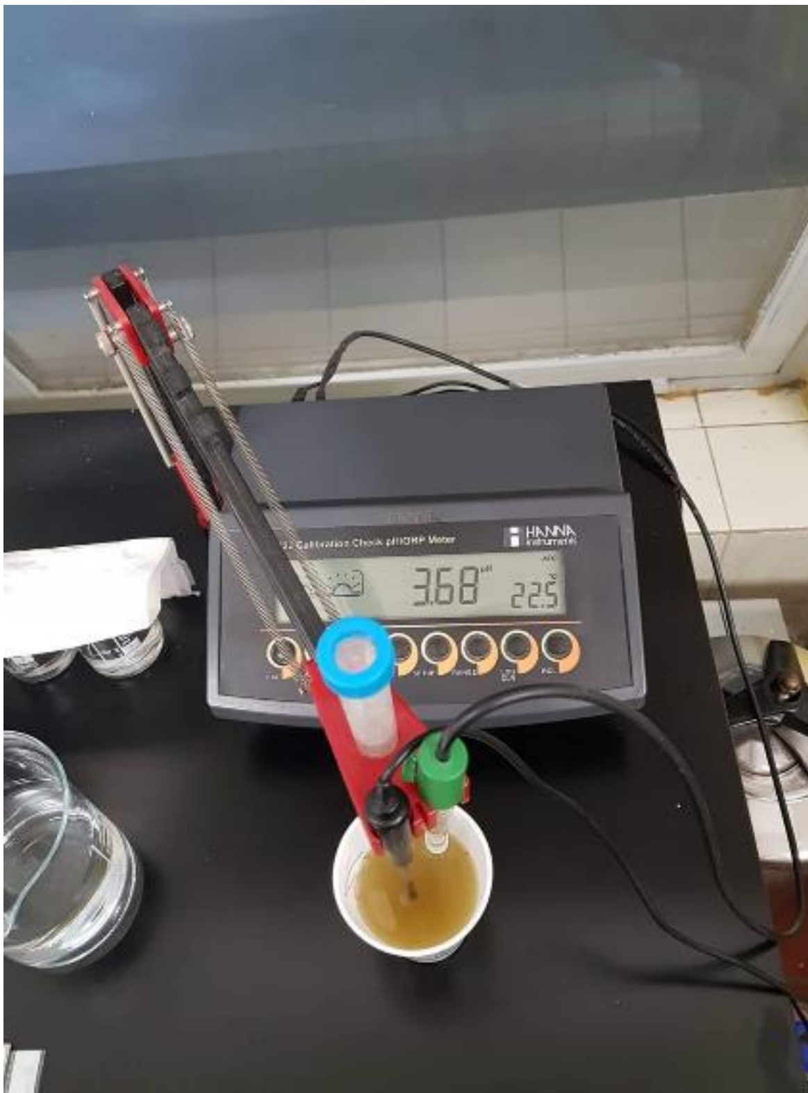
Slika 11. Mjerenje realnog aciditeta mošta (Izvor: Mesarić, 2018.)
