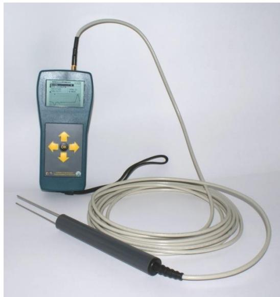
Slika 37. TDR senzor vlage
