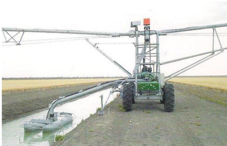
Slika 11. Prenosivi sustav navodnjavanja
