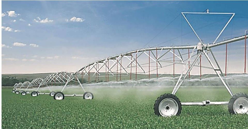
Slika 16. Samohodni automatizirani uređaj za linijsko ili kružno navodnjavanje
