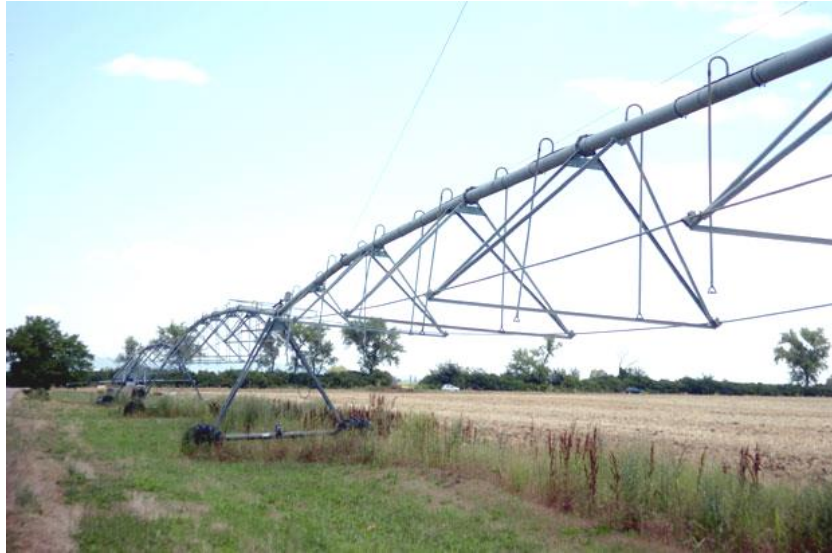
Slika 20. Pivot sustav - kišno krilo (Izvor: https://www.pkb.rs/navodnjavanje.htm )
