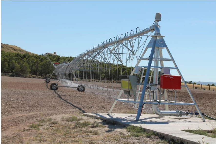
Slika 12. Polustabilni sustav navodnjavanja (Izvor: http://www.iceinnova.com/ice-pivot-2/ )
