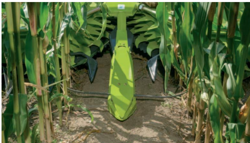
Slika 11. Razdjeljivači s dodirnim ticalima (Izvor: https://www.claas.co.uk )
