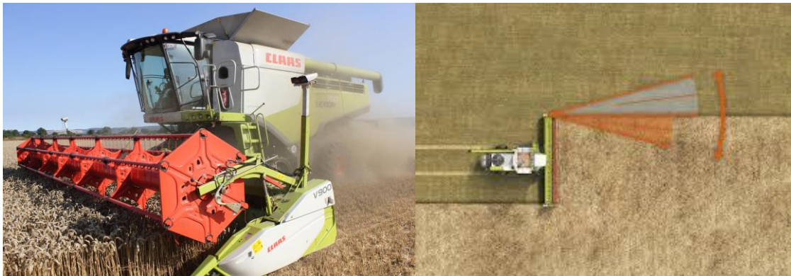
Slika 12. Lasersko upravljanje kombajnom (Izvor: https://www.claas.co.uk )
