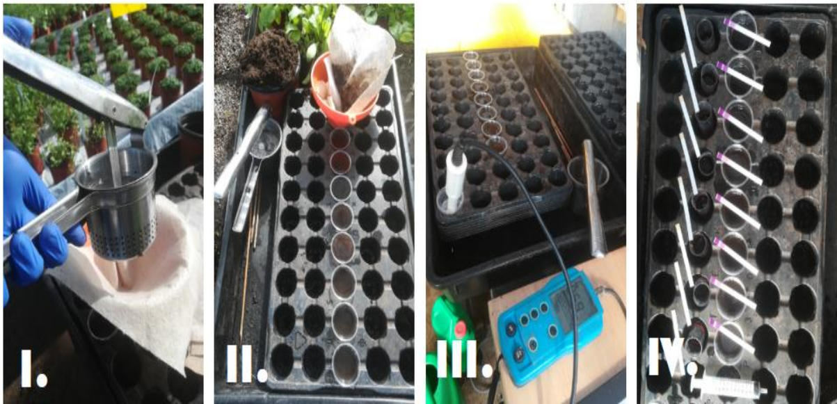
Slika 8. I. metalna preša, II. uzimanje uzoraka za analizu, III. mjerenje EC i pH otopine tla, IV. nitratni test
