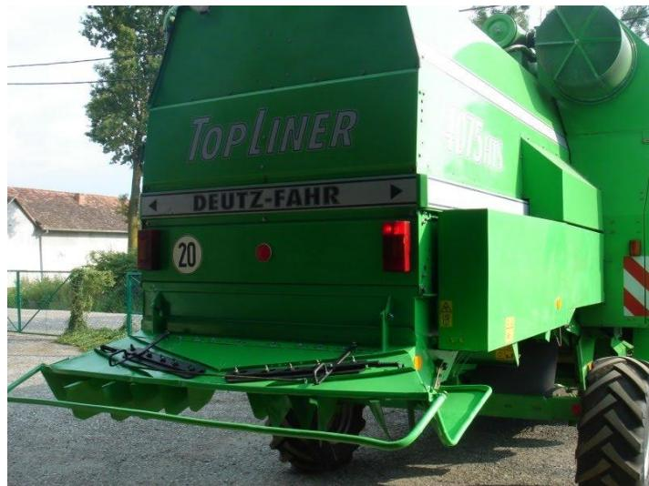
Slika 7. Sječkalica kombajna Deutz Fahr topliner 4075 hts
