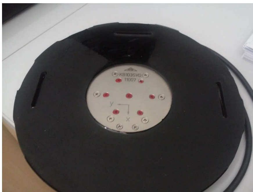
Slika 8. Prikaz pravca mjerenja za osi x, y i z (izvor: vlastita fotografija)
