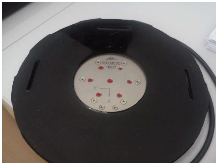
Slika 8. Prikaz pravca mjerenja za osi x, y i z (izvor: vlastita fotografija)
